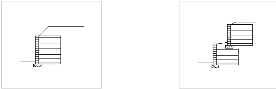
[그림] 보강토 옹벽 설치 형상
